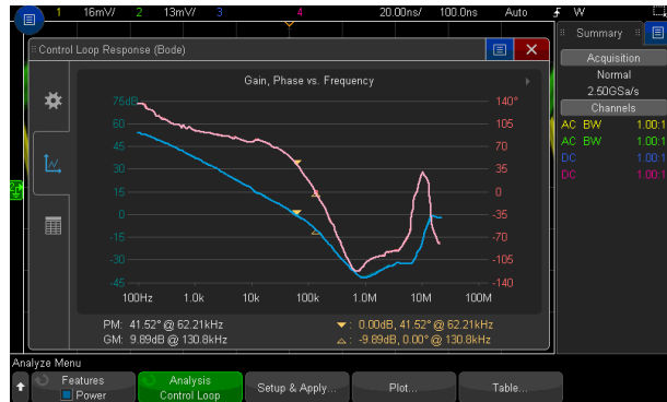
Figura 3: Test di risposta del loop di controllo utilizzando l'automotive better bundle DSOX3054AUT.
